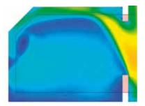
Cut plots – 0,1 m  $\approx$  0,33 ft , 1,1 m  $\approx$  3,6 ft and 1,7 m  $\approx$ 5,6 ft above the floor - air velocity (displayed interval 0 - 0, 5 m / s ;0-98,4 ft / min).
